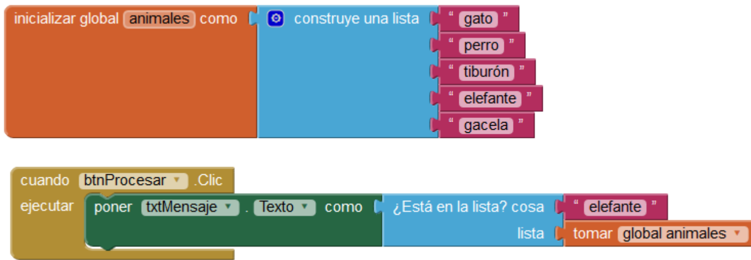
Imagen 110: Chequea si el ítem "elefante" está en la lista retornando "true" o "false". Se considera mayúscula y minúscula
