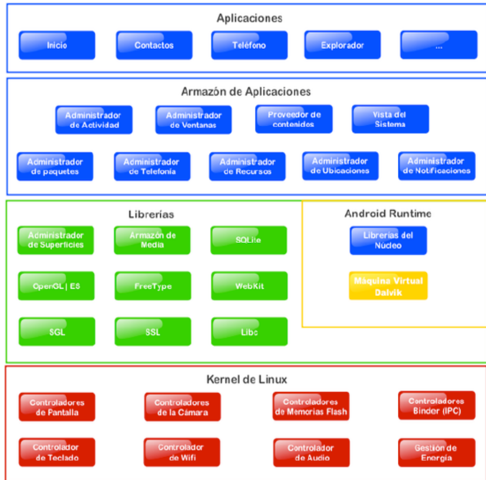
Ilustración 4. Arquitectura de Android [11]
