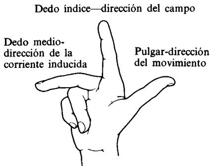
Figura 10.5.—Regla de la mano derecha, de Fleming.
